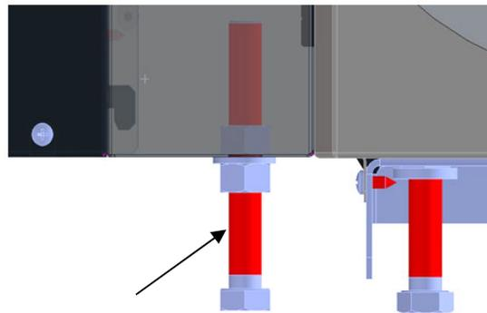
Den Stützfuß mittels beigelegter Schraube M16, Mutter M16 und Scheibe M16 auf Höhe einstellen und kontern (innen und außen).
