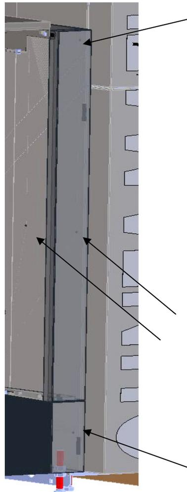
Hydroeinheit mittels beigelegten Blechschrauben am Kessel (hinten bündig damit man die Tür vorne problemlos öffnen kann) an den Löchern von innen nach außen anschrauben.
